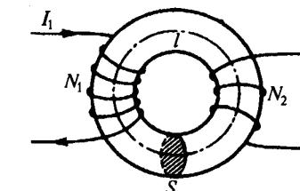
Первая катушка с числом витков  $N_1$  и током  $I_1$  создаёт поле  $B = \mu_0 \mu \frac{N_1 I_1}{l}$ . Магнитный поток сквозь один виток второй катушки  $\Phi_2 = BS = \mu_0 \mu \frac{N_1 I_1}{l} S$ , где  $l$  – длина сердечника по средней линии. Тогда полный магнитный поток (потокосцепление) сквозь вторичную обмотку, содержащую  $N_2$  витков
