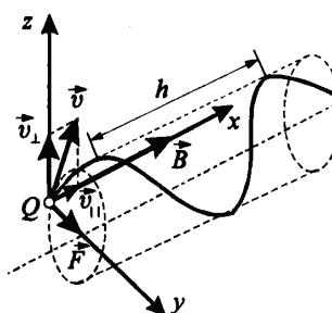
Суммарное движение будет движением по спирали, ось которой параллельна магнитному полю. Шаг винтовой линии  $h = v_{||}T = vT \cos \alpha$ , где
