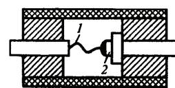
В точечных диодах  $p-n$ -переход образуется в точке касания металлического контакта 1 и полупроводника 2 (например, в точечном германиевом диоде диффузия алюминия в  $n$ -германий образует в германии  $p$ -слой). Технология изготовления германьевого плоскостного диода описана выше.
