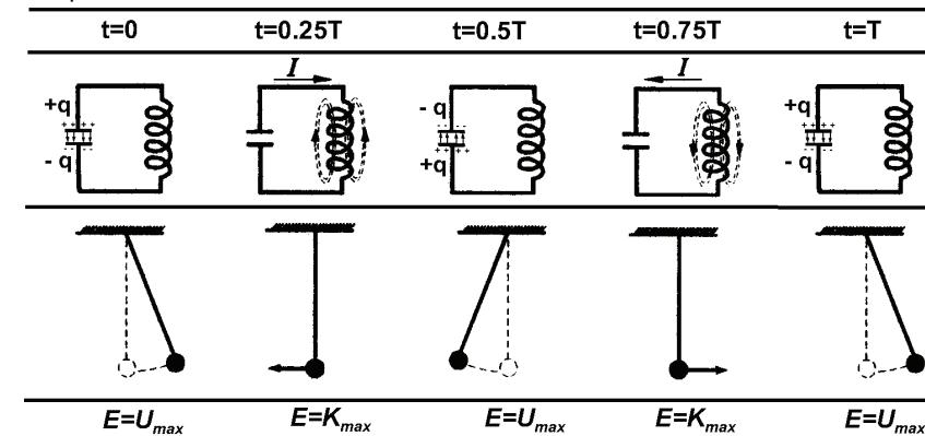
Пусть в начальный момент времени  $t = 0$  конденсатор заряжен зарядом  $q$ . Тогда энергия электрического поля между обкладками конденсатора  $W_e = \frac{q^2}{2C}$ . При замыкании конденсатора на катушку индуктивности, в контуре потечёт возрастающий ток  $I$ . Энергия электрического поля начнёт уменьшаться, а энергия магнитного поля катушки  $W_m = \frac{LI^2}{2} = \frac{L\dot{q}^2}{2}$  будет возрастать. Поскольку потерь в контуре нет ( $R = 0$ ), то полная энергия
