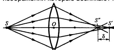
**Сферическая aberrация.** Фокус  $S''$  для лучей, более удалённых от оптической оси чем параксиальные, находится ближе, чем фокус  $S'$  параксиальных лучей. В результате изображение светящейся точки имеет вид расплывчатого пятна.
