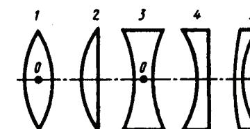
Линза называется **тонкой**, если её толщина значительно меньше, чем радиусы кривизны  $R_1$  и  $R_2$  обеих поверхностей. На оптических схемах линзы обычно обозначают двунаправленной стрелкой.
