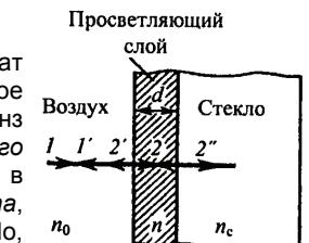
оптическую систему будет максимальна. Этого можно добиться, например, нанесением на поверхность линз тонких пленок с показателем преломления  $n_0 < n < n_c$ , причём  $n = \sqrt{n_0 n_c}$ . В этом случае амплитуды когерентных лучей 1' и 2" будут одинаковы, а условие минимума для отражённых лучей ( $i=0$ ) будет  $2nd = (2m+1)\frac{\lambda}{2}$ . При  $m=0$  оптическая толщина пленки  $nd$  удовлетворяет условию
